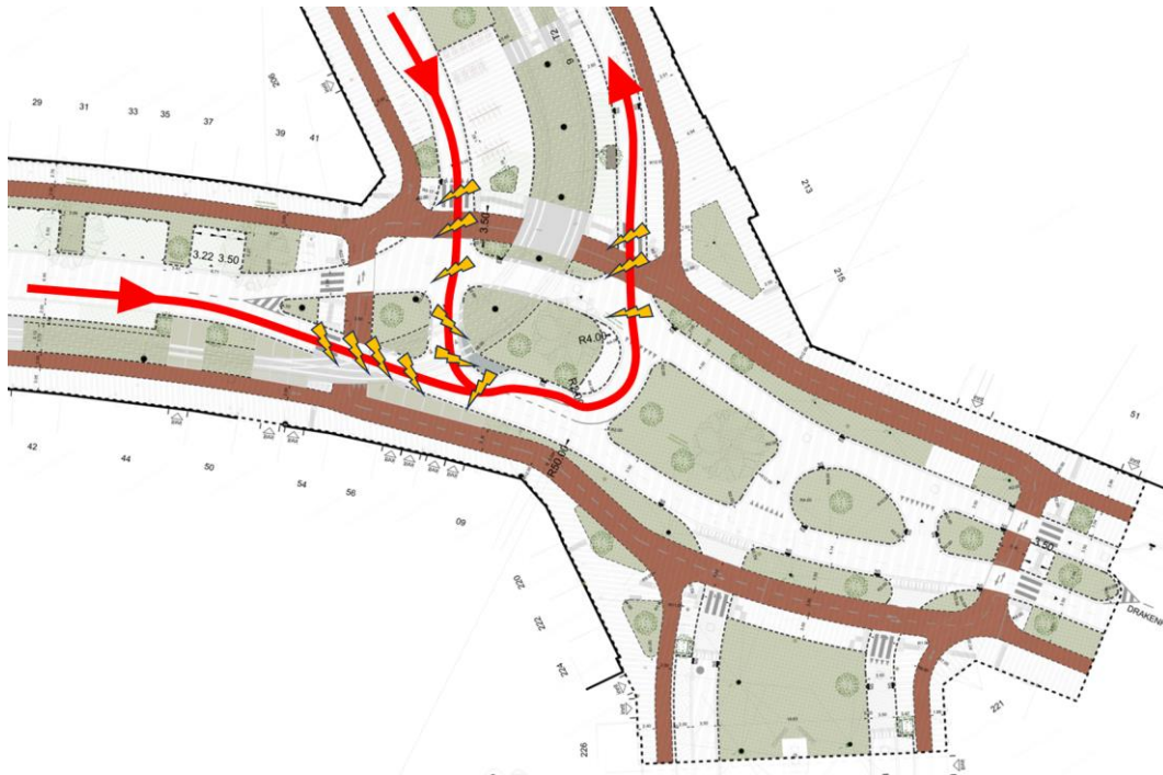
Figuur 6 - Conflictsituaties met autoverkeer op kruispunt Boekenberglei-Drakenhoflaan wegens het dichtmaken van oversteek Cruyslei-Boekenberglei waardoor alle verkeer het nieuwe kruispunt moet gebruiken.
