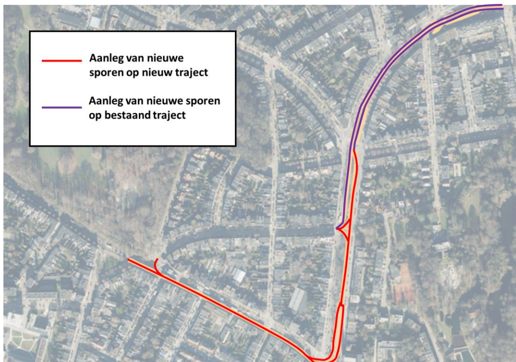
Figuur 18 - Aanleg van nieuwe traminfrastructuur in de projectzone.
