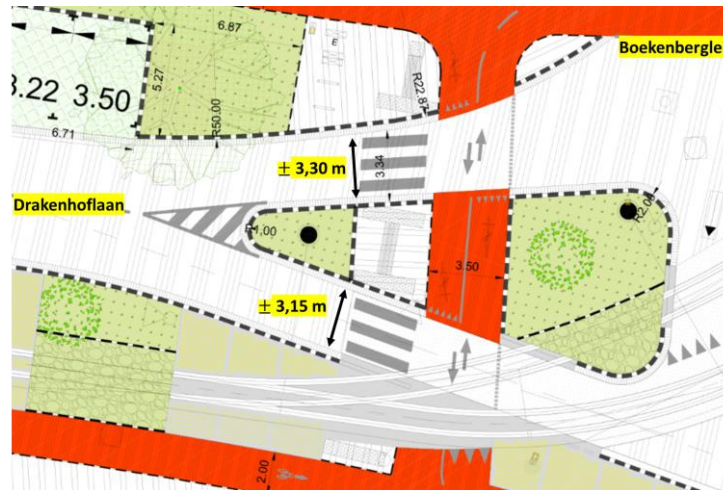
Figuur 30 – Oversteekplaats bij kruispunt Boekenberglei-Drakenhoflaan voldoet niet aan de minimale eisen gesteld door de brandweer (wegbreedte minstens 3,50 meter).
