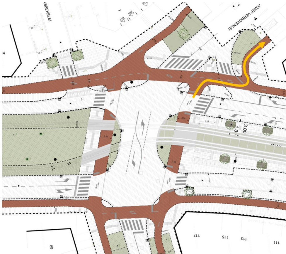
Figuur 15 – Nieuwe toestand van kruispunt Boekenbergselei-Menegemlei blijft onoverzichtelijk. Fietsers moeten veel scherpe bochten nemen (o.a. een onmogelijke bocht richting Jozef Verbovenlei, aangeduid met gele pijl) en beschikken over zeer kleine opstelvakken die niet voorzien zijn op de verkeersstroom.
